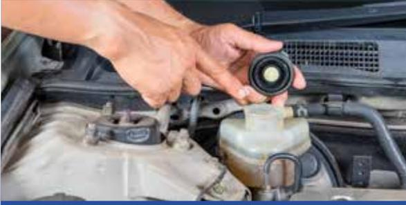
El líquido de frenos **AD DOT 4 MEGA + 6** se aplica en circuitos hidráulicos de frenos y embragues que precisen de un punto de ebullición en seco por encima de 265°C y en húmedo superiores a 175°C. Su baja viscosidad, lo hacen especialmente recomendado para sistemas de frenos que combinen ABS, ASC.
